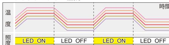
温度は2ステップ温調でLEDランプをON-OFFさせることができます。温度と照度により昼夜運転が可能です。
